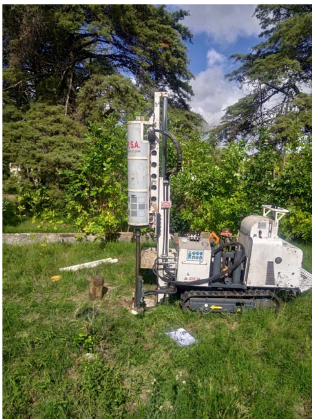
Figura 2. Equipo de perforación y ejecución de ensayos SPT utilizado en el Estudio
